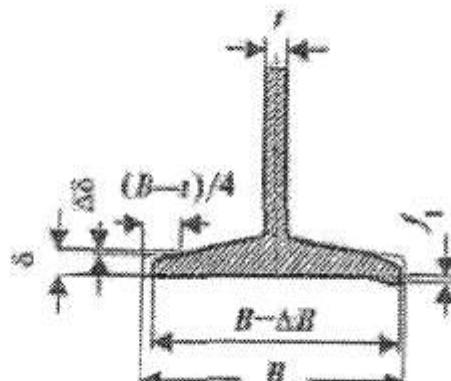
Схема проведения измерений величин износа и отгиба полки монорельса при проведении его дефектации.  $B$  — первоначальная ширина полки;  $\Delta B$  — износ полки;  $t$  — толщина стенки;  $f$  — отгиб полки;  $\delta$  — первоначальная толщина полки на расстоянии  $(B-t) / 4$  от края;  $\Delta\delta$  — уменьшение толщины полки вследствие износа
