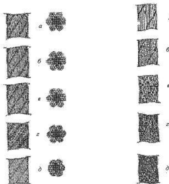
Рис. 5. Износ наружных проволок каната крестовой свивки:
