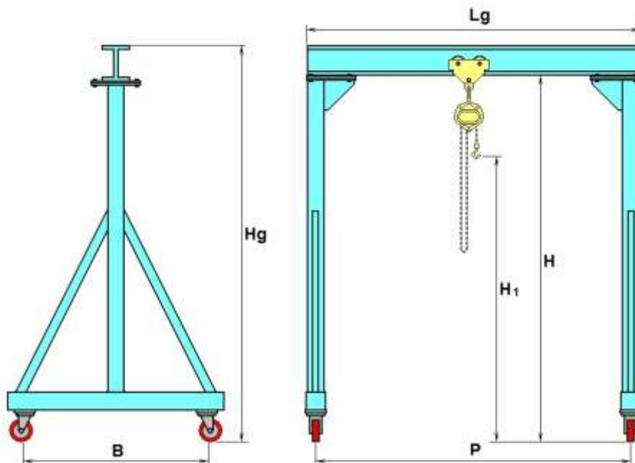
Стандартная комплектация: колеса 2-а поворотные с тормозом, 2-а неповоротные, без тали.
